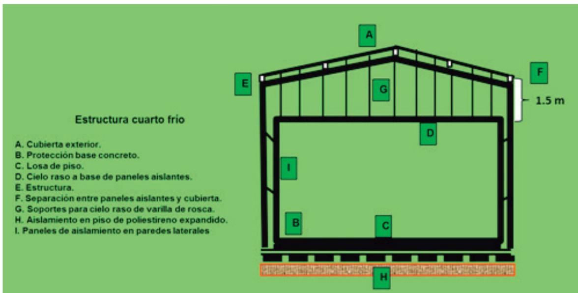
Figura 52. Gráfico mostrando una estructura general para cuarto frío con paredes de paneles aislantes y techo protector (Meneses, 2001).
