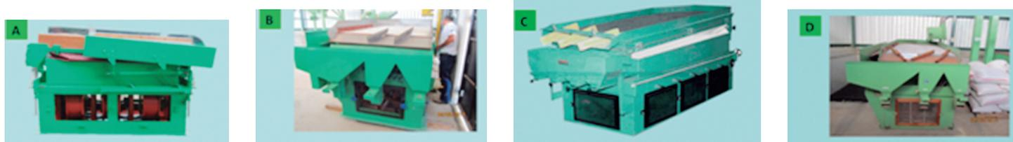
Figura 45. Equipos para la clasificación por densimetría A) capacidad de 20 a 80 quintales por hora. FIATA-Nicaragua. B) Equipos densimétrica de 80 quintales por hora de capacidad. C) y D) Equipos de 80 quintales por hora. SABINA Industria Fotografías Néstor Bonilla Bird.
