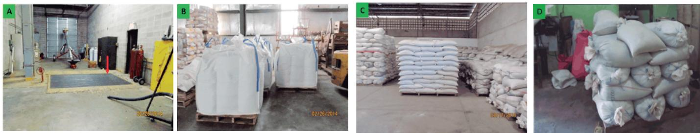
Figura 6. Diferentes formas de recepción de semillas en las plantas de procesamiento industrial. Fotografía (A) muestra tolva de recepción de bajo nivel, en el piso se observa un enrejado metálico por donde se descargan las semillas por gravedad. Fotografía (B) recepción de semillas en bolsas de polietileno de 1,000 kg. Fotografías (C) y (D) recepción de semillas en sacos de polietileno de 50 kg. Fotografías Néstor Bonilla Bird.
