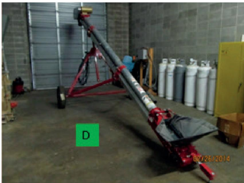
Figura 7. A) transportador helicoidal de 10 a 50 cm de diámetro. Foto FIATA, B) elevador de cangilones de aproximadamente 90 kg a 180 kg/h (20 a 40 qq/h). Foto FIATA. C) transportador de banda para sacos de polietileno de 50 kg. Foto FIATA. D) Elevador helicoidal. Néstor Bonilla Bird.
