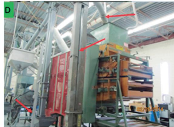
Figura 35. Diferentes ángulos de la máquina clasificadora a base de aire-zaranda. A) Tolva de recepción en la parte superior. B) Disposición de las zarandas. C) Ventilador de succión de impurezas de menor peso específico que las semillas. D) Transportador de descarga en la tolva de alimentación.
