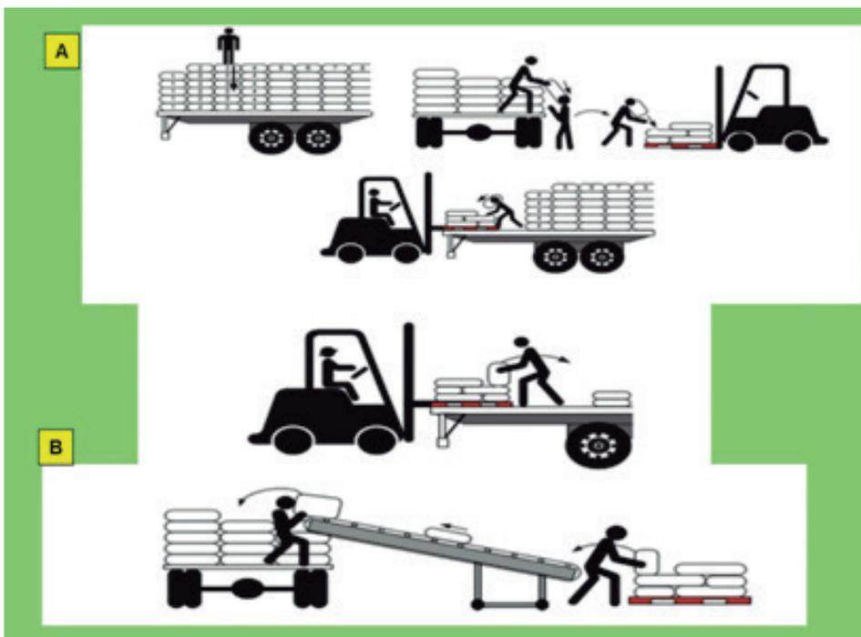
Figura 55. Diagramas mostrando (A) manipulación manual de sacos o bolsas de semillas con el auxilio de un montacargas (B) Descarga manual con el auxilio de banda transportadora de camión transportando sacos o bolsas de semillas (Martínez, 2014).
