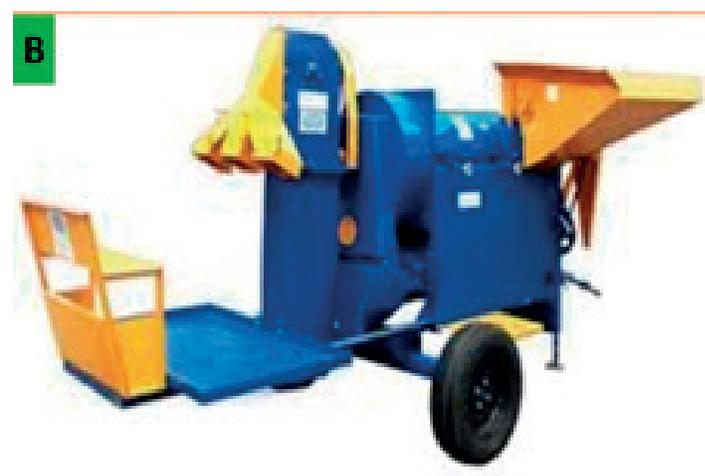
Figura 3. Equipos aporreadores de frijol y para trillado de espigas de sorgo y arroz. (A) Aporreador de 30-50 qq/h. (B) Aporreadora de 50-80 qq/h. Foto FIATA.
