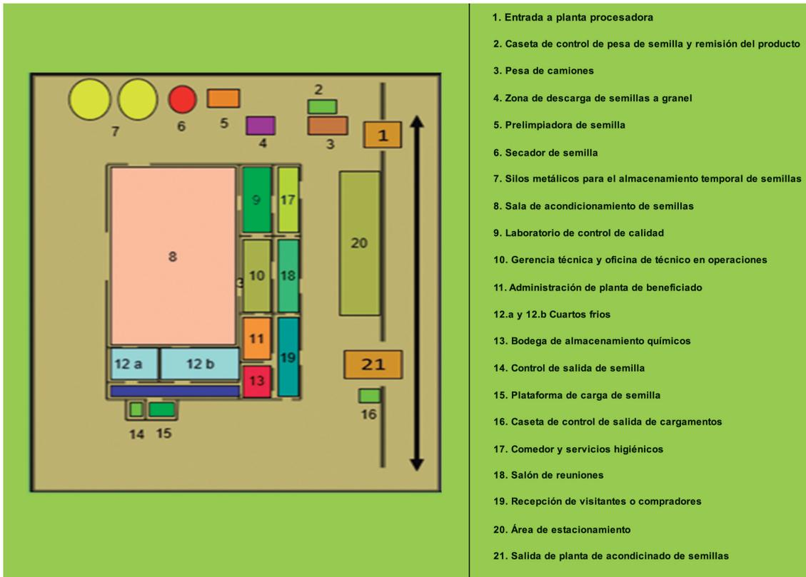
Figura 58. Plano sugerido para la distribución horizontal de áreas de trabajo en una planta de procesamiento y clasificación de semillas. Adaptado de Brooker Donald (1992), *Drying and Storage of Grain and Oil Seeds*. USA.
