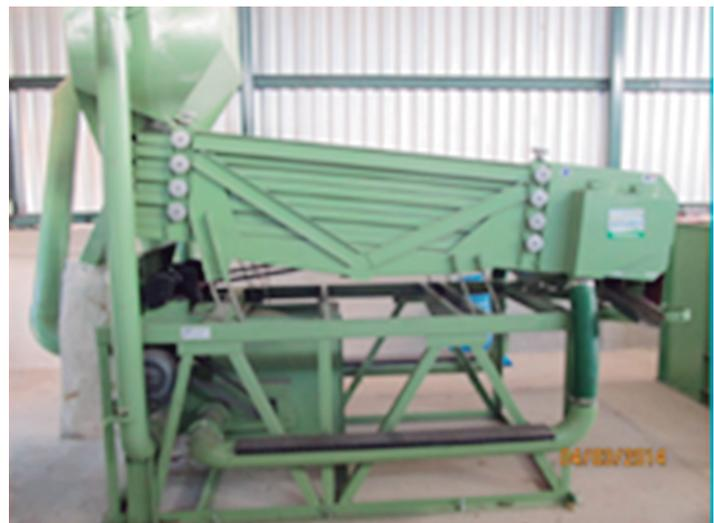
Figura 18. Fotos A, B y C. Equipos de prelimpiado con capacidad de 20 a 300 qq/h. FIATA-Nicaragua. D) Equipo prelimpiado SABINA INDUSTRIAL Foto Néstor Bonilla Bird.
