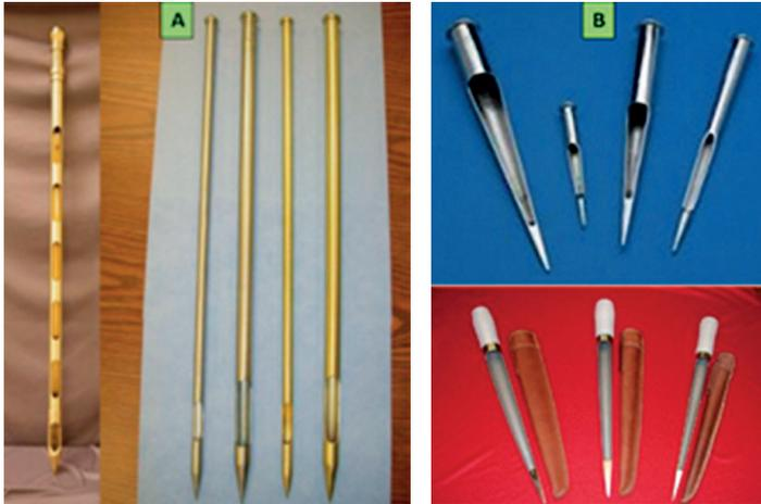
Figura 9. A) Tipos de sondas para tomas de muestras o caladores para semillas en sacos y a granel. B) Muestra de caladores o “chuzos” para la toma de muestras de sacos y bolsas de semillas. Fotos de Seedburo, 2014.
