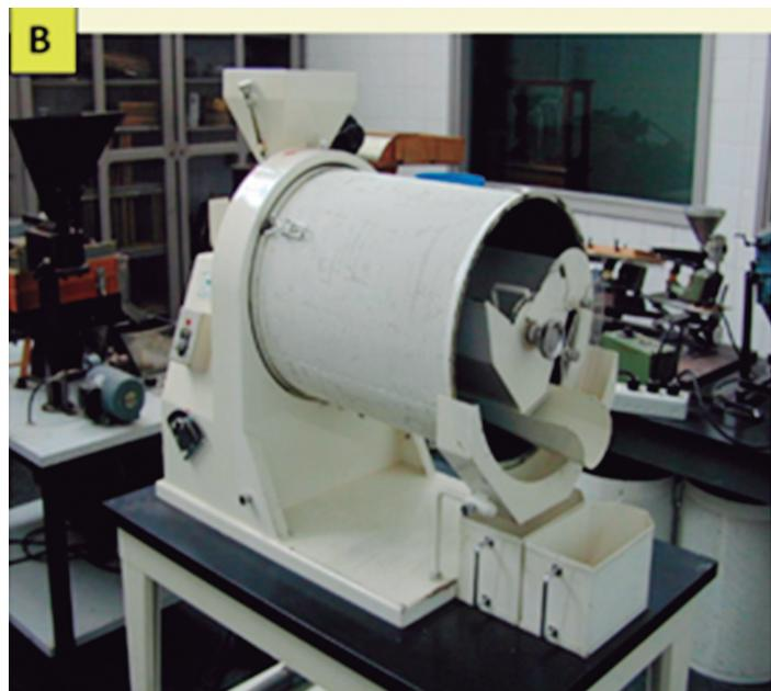
Figura 39. Cilindro indentado seleccionador por longitud de semillas (A) disposición doble cilindro y (B) cilindro individual. Fotografía (A) tomada de Google, y (B) de (Wilson, 2014).
