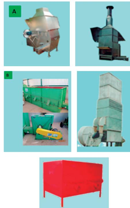
Figura 21. Secadores estacionarios de fabricación nacional (A) parte superior hornos de cascarillas para fuego indirecto de 2 a 4 millones de BTU. Izquierda parte inferior secador estático de 40 a 100 quintales de capacidad. Parte inferior derecha, secadores columnares de wafles o cribas de 100 a 800 quintales de capacidad. FIATA-Nicaragua. (B) Secador estático de 40 quintales. SABINA Industrial, Fotografía Néstor Bonilla Bird.
