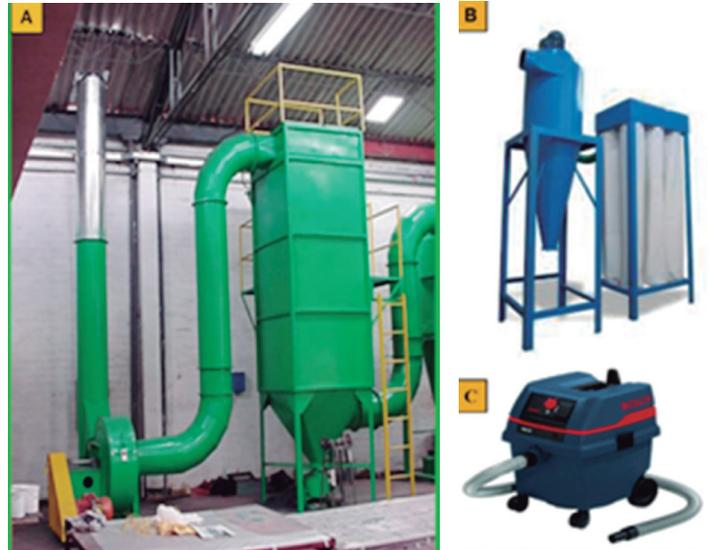
Figura 61. Fotografías mostrando colectores de partículas de polvo, rastrojos y contaminantes; (A) aspirador de polvos contaminantes industrial, (B) aspirador para ubicarse individualmente en cada equipo de acondicionamiento de semillas, y (C) aspirador de polvo portátil para la limpieza de áreas de trabajo. Fotografías Google: colectores de partículas.
